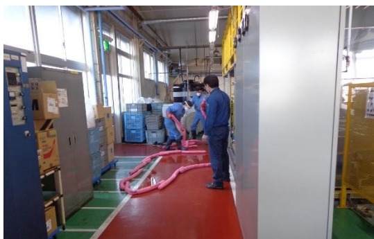
水系洗浄機 緊急事態訓練の様相 (洗浄液流出の漏洩防止)
