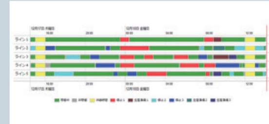
稼働状況と停止理由を凡例毎に色分けして表示します。グラフにカーソルを合わせると詳細データ(停止理由、停止時間など)を確認できます。
