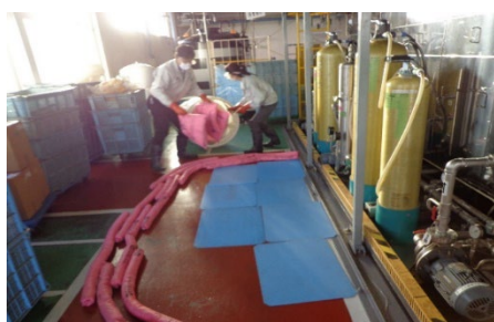
水系洗浄機 緊急事態訓練の様様 (洗浄液流出の漏洩防止)
